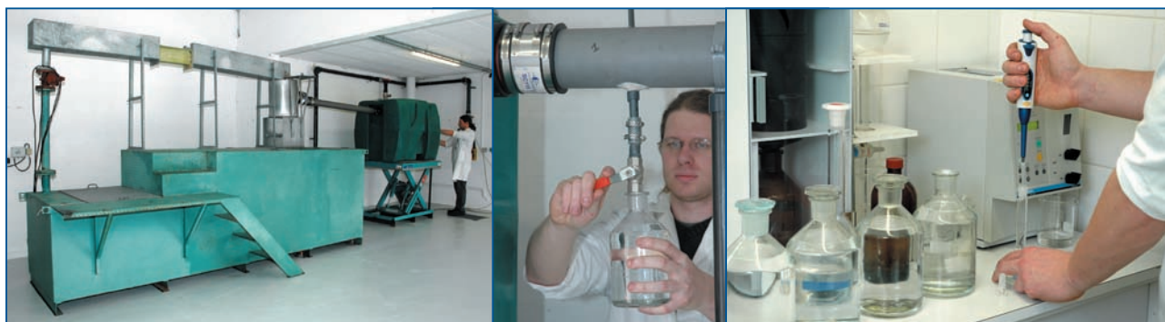
Laboratorul de încercări: verificarea performanțelor unui separator de hidrocarburi
